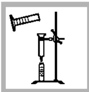
10. 将 25-mL 的样品管放在萃取器下，用 25-mL 塑料量筒加入 25mL pPb-3 Eluant 洗提液到萃取器中。
