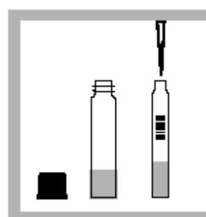
7. 吸4.0mL反应管内溶液到比色管内。
