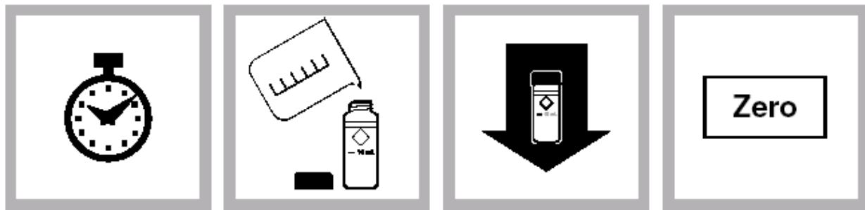
5. 当定时器发出蜂鸣声后，按定时器图标，按“OK”启动一个 5 分钟的反映步骤。如果水样中含有硝酸盐，则水样呈琥珀色
