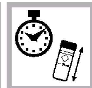
5. 当定时器发出蜂鸣声后，按定时器图标，按“OK”启动一个 2 分钟的反映步骤。
