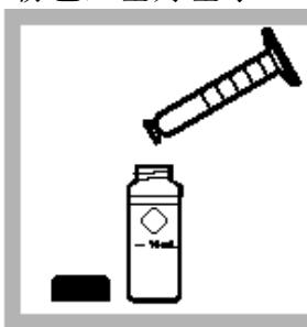
10. 将量筒中剩余的10mL溶液倒入另一个样品管中 (待测样品) 。
