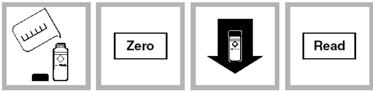
5. 当定时器发出蜂鸣声后，在第二个圆形样品池中加入 10mL Cu”水样，置入比色器中读数
