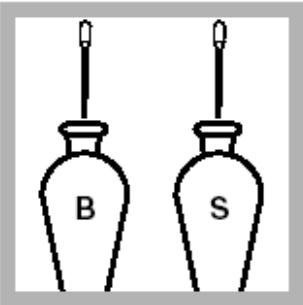
10. 用校准过的1.0mL塑料点滴器分别加入2.0 mL的12 N氢氧化钾标准溶液到两个漏斗中，盖好盖子，摇晃混合。
