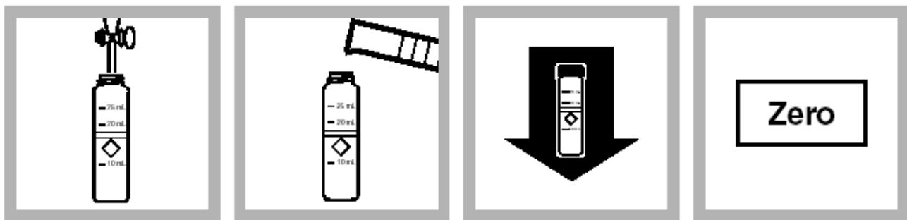
9. 将上层的苯溶液倒入一个干净的25mL比色瓶中(待测样品)。
