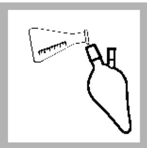
13. 把消化后样品倒入冷蒸气洗瓶。
