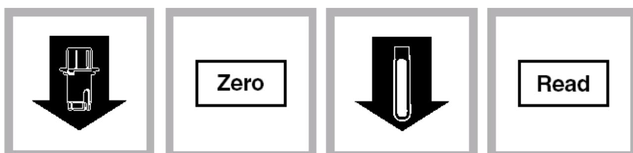
5. 将测试管适配器放入比色瓶槽。计时器鸣叫时, 将空白样品放入比色瓶槽
