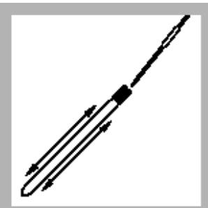
5、将试管斜放 45 度，加入 2ml 试样（测试 0 ~ 15,000 mg/L 时加 0.2mL 试样）。
