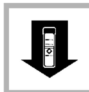
15. 当计时器鸣叫时，将样品管放入样品管槽。
