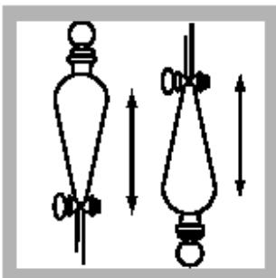
10. 倒转漏斗，不时通通气。适量摇晃漏斗并通气。然后剧烈地摇晃两个漏斗 30 秒（必要时通气）。
