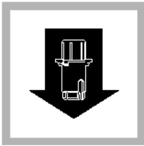
7. 安装好16-mm样品适配器, 放入。反应时间到, 把零号空白管放入。
