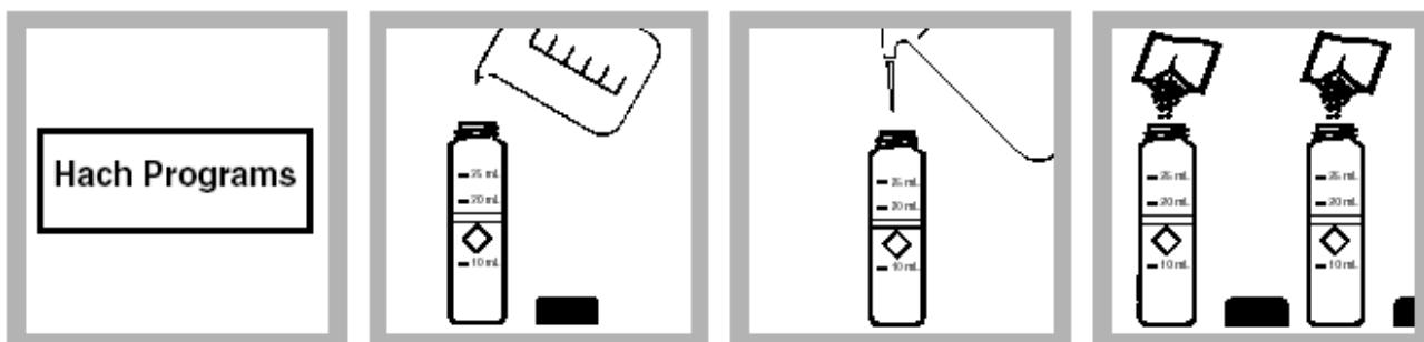
1. 在 HACH PROGRAM. 下, 选择所需的氧scavenger程序, 181 0 Scav-Carbohy 或 HACH PROGRAM: 182 0 Scav-DEHA 或 HACH PROGRAM: 183 0 Scav-Hydroquin 或 HACH PROGRAM: 184 0 Scav-Iso-As. 或HACH PROGRAM: 185 0 Scav-MEKO, 按START。
