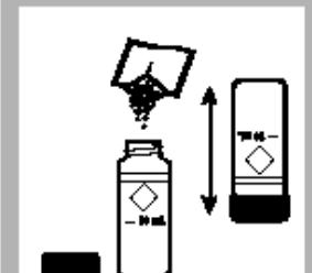
4. 加入过碘酸钠到比色瓶中, 盖上盖, 倒转多次混合。注:若有锰, 有紫色产生。
