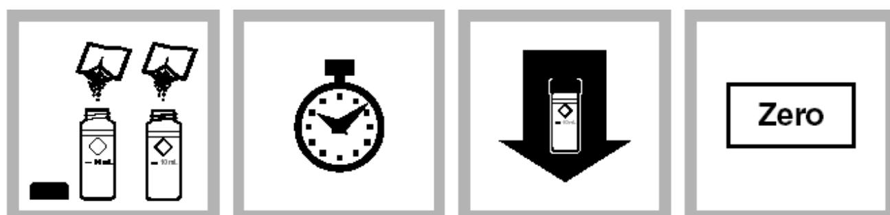
5. 加入一包Porphyrin 2 试剂粉包到每个比色管中。混合使溶解。
