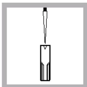
14.反应后，按加显色液顺序加入停止显色液，并放入架中，摇晃。
