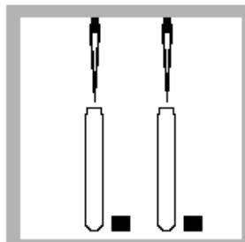
3、取 0.5 ml 水样加入其中一管，为待测组；另取 0.5 ml 无氨水（蒸馏水、纯水）加入另一管，做为空白组。放入 COD 加热器内，加热 30 分钟。
