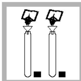
8、打开已冷却的二比色管盖子，再各加入总氮试剂 A。
