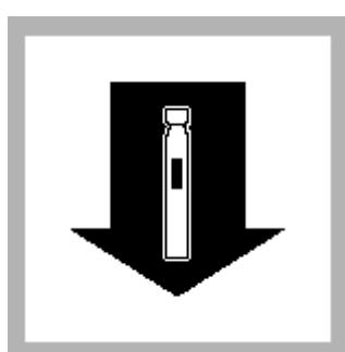
9. 擦干净比色管, 放入样品适配器, 按READ, 结果显示mg/L SO<sub>4</sub><sup>2-</sup>。
