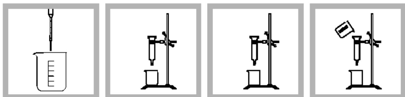
5. 当计时器鸣叫时, 用另一个1 mL 塑料点滴器加入 2.0 mL pPb-2 固定溶液, 混合。
