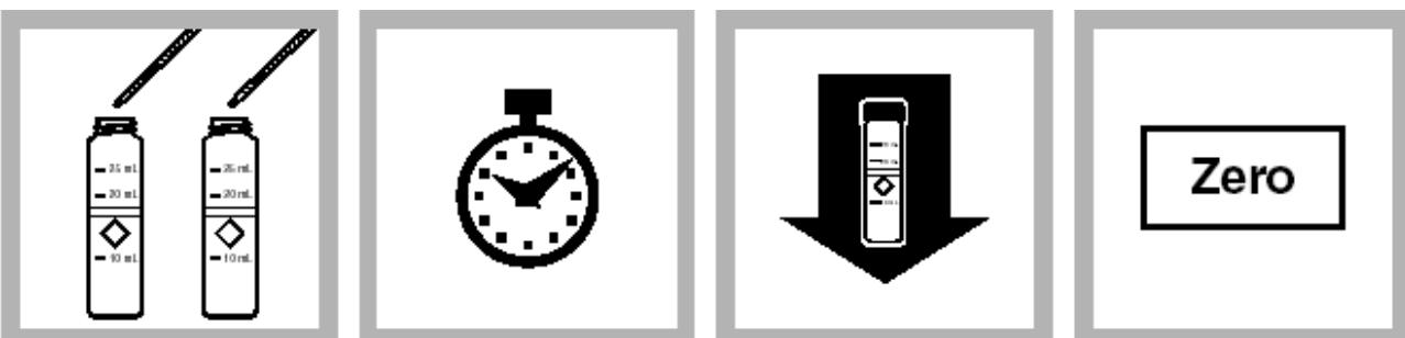
5. 分别量取 5.0 mL 碳酸钠溶液到两个管中, 混合。
