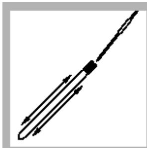
6、将试管斜放 45 度，加入 2ml 去离子水（测试 0 ~ 15,000 mg/L 时加 0.2mL 水）。
