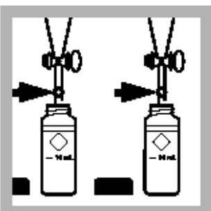
16. 分别在两个分液漏斗的出液管中塞入棉花，缓慢地将甲苯分出到相应的标记着“空白试样”和“样品”的比色管中，盖好比色管。
