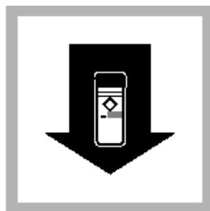
12. 计时器鸣叫后五分钟内, 将空白试样放入样品槽, 关上遮光盖。
