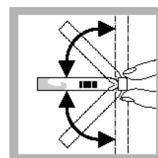
8. 盖好反应管，倒转多次混合。
