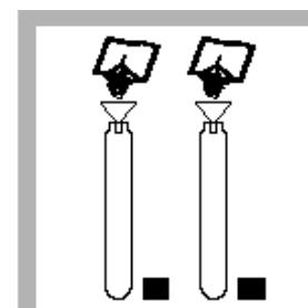
11、反应时间到，再各加入总氮试剂 B。
