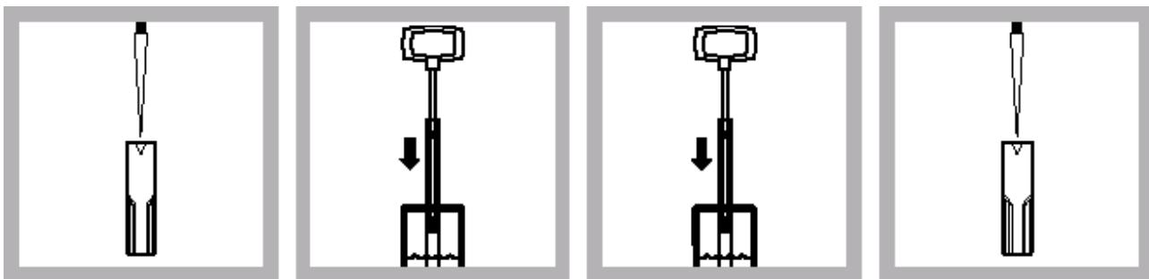
5. 如果测量土壤: 向每个样品管中加入0.5mL稀释液.
