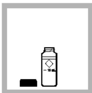
8. 将一滴ECR Masking 试剂溶液滴入一个干净的样品管中, 以此作为空白。
