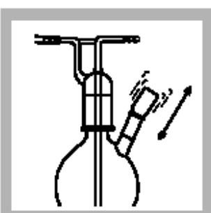
22. 摆动HgEx Reagent A试剂瓶，从瓶颈口加入洗气瓶。
