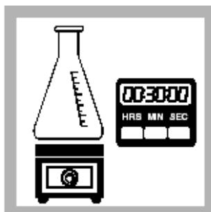
4、将锥形瓶放在加热板，缓缓加热 30 分钟。避免蒸干。
