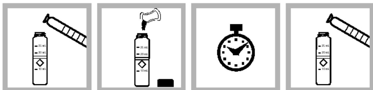
5. 往一个干净的配 套的比色管装入待 测样品至25mL刻度 线。保留余下的 25mL待测样品用于 步骤8。
