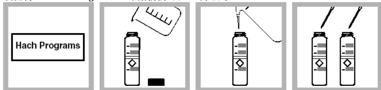
1. 在HACH PROGRAM下，选择硫氰酸汞法程序，屏幕显示: 70 Chloride, 按Start。
