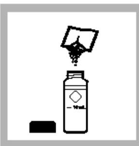
6. 将 DPD 自由余氯试剂药包加入一个试样, 盖上瓶口摇晃均匀。
