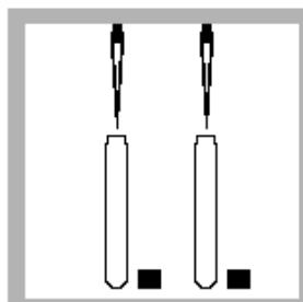
3、取 2 ml 水样加入其中一管，为待测组；另取 2 ml 无氨水（蒸馏水、纯水）加入另一管，做为空白组。放入 COD 加热器内，加热 30 分钟。
