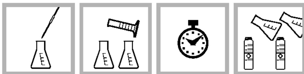
5. 准确量取2.0 mL样品到另一个125mL的塑料锥形瓶中（待测试样）。
