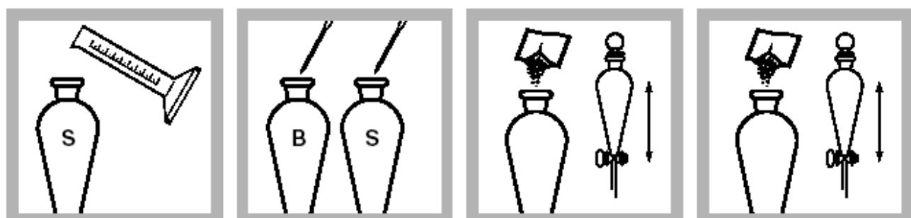
5. 将量取好的样品倒入另一个500mL分液漏斗中(待测试样)。
