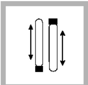
8、握住瓶盖充分摇晃混合，置于预热好的分解炉。
