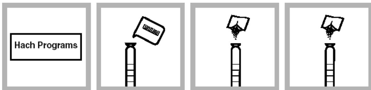
1. 在 HACH PROGRAM下, 输入试铝灵法程序编号10 , Aluminum, Aluminon, 按Start。
