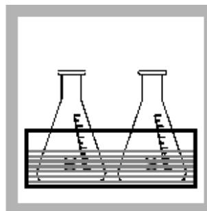
5. 分别加入5.0 mL的硫酸盐形式的缓冲溶液, pH2.0, 到每个瓶, 混合。
