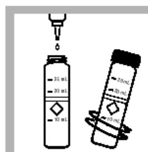
17. 取出样品管，加入6滴pPb-6 脱色溶液到样品管中，充分混合。
