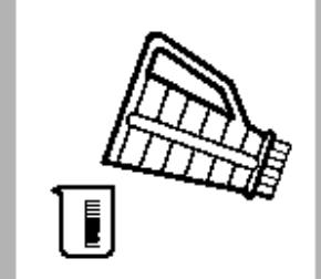
2、测试范围 0~15,000mg/L 的试样，以 100mL 试样均匀搅拌后，倒入 250mL 烧杯。
