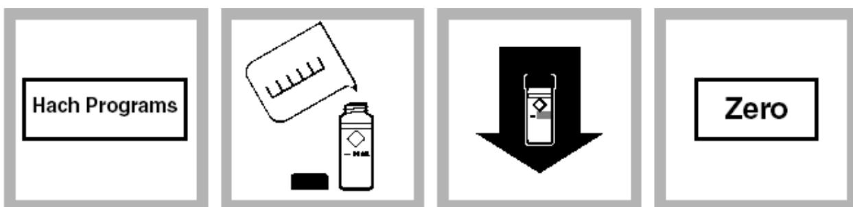
1. 在 HACH PROGRAM 下, 选择二氧化氯的程序编号76, 按START。注: 样品必须立即分析; 为得到最佳结果, 对每种试剂均测定试剂空白。
