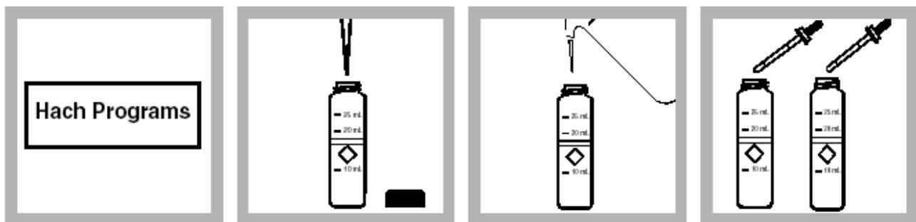
1. 在HACH PROGRAM.下,选择硫化物程序690 Sulfide, 按START。
