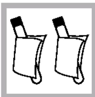
1. 将瓶放入已预热到150° C的COD反应炉中，消化一小时。
