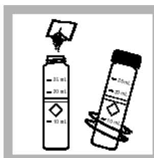
13. 加入一包 pPb-5 指示剂粉包到样品中，充分混合。注：溶液颜色将变棕色。
