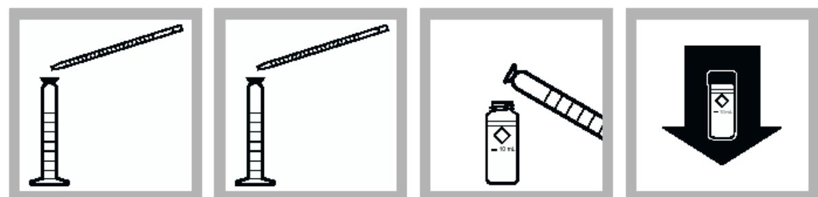
9. 当定时器显示 **12: 00**, 在空白样量筒中加入 2.5ml 低量程甲醛显影液, 塞上塞子, 倒置混合
