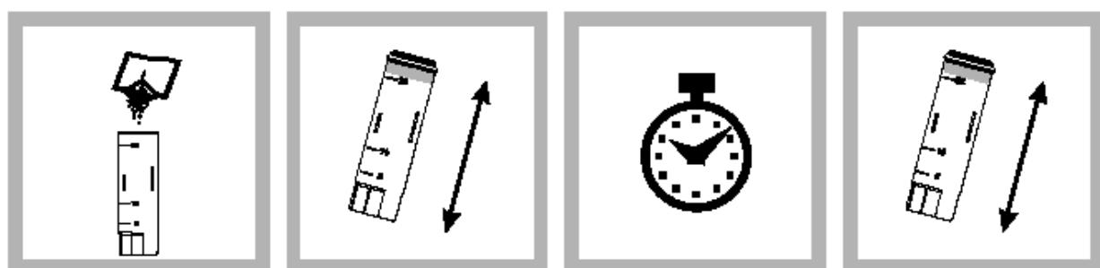
5. 加入一包 BoroTrace #2 试剂粉包到加有样品的样品管中。
