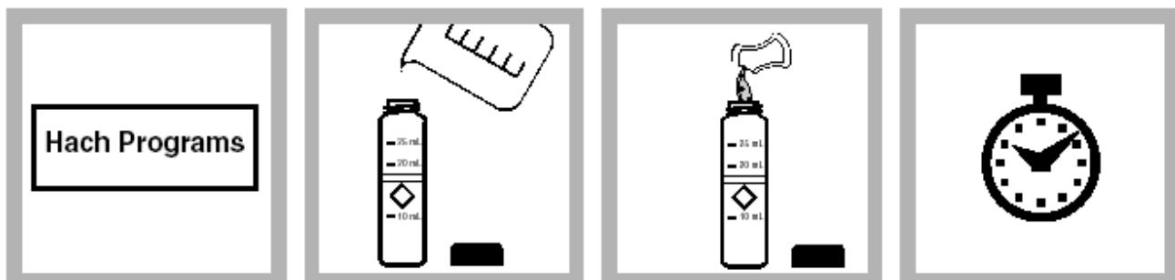
1. 在 HACH PROGRAM下, 选择铁的程序 260 Iron, FerroZine , 按 START。
