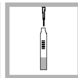
12. 吸0.3mL Masking 溶液 C (HCT152 C)入比色管。
