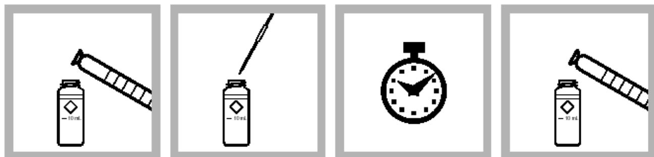
5. 将 10 mL 待测试样倒入一个配套的比色瓶中。
