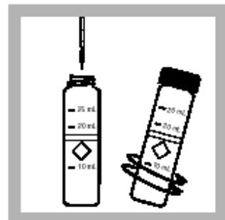
12. 用 1-mL 塑料点滴器，加入 1.0 mL pPb-4 中和溶液到样品管中，充分混合，立即进行步骤 13。
