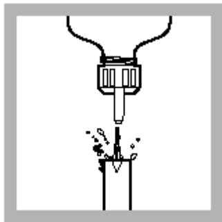
13. 用去离子水彻底清洗每个试管4次，将洗液倒入废液容器中，清空试管。 注意：要确保清洗液体排出干净，最后可以在纸巾上，上下轻轻敲击试管以便排水
