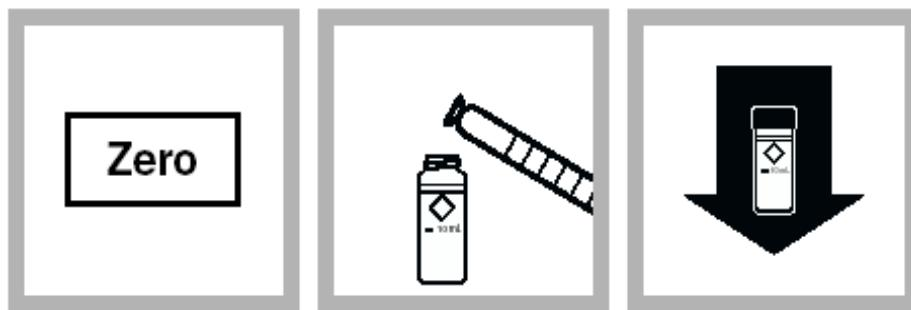
13. 当定时器显示 2:00, 点击 “Zero”, 将检测样倒入样品池, 擦干样品池, 屏幕显示 “0.00 ug/L”
