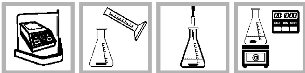
1. 开启 COD 反应器，加热到 103-105 °C。将塑料罩放在反应器前面。
