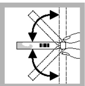
16. 盖好反应管, 倒转多次混合。
