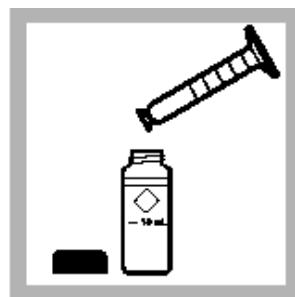
9. 从量筒中倒出 10mL混合液到已滴有ECR Masking 试剂溶液的样品管 (空白试样) 中, 离心混合。注: 溶液将开始变黄。
