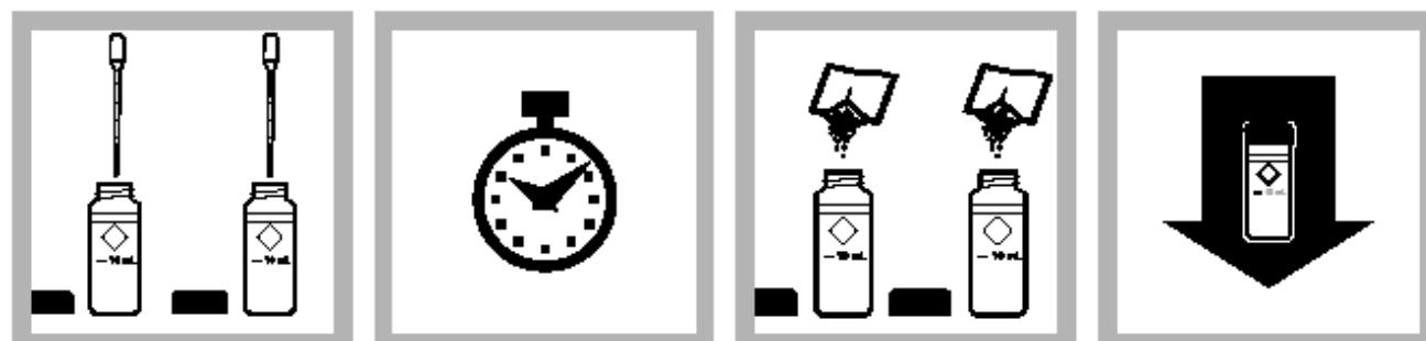
5. 加入 0.5 mL 的 0.3%的PAN 指示剂溶液到每个比色瓶中。盖好, 倒转多次混合。
