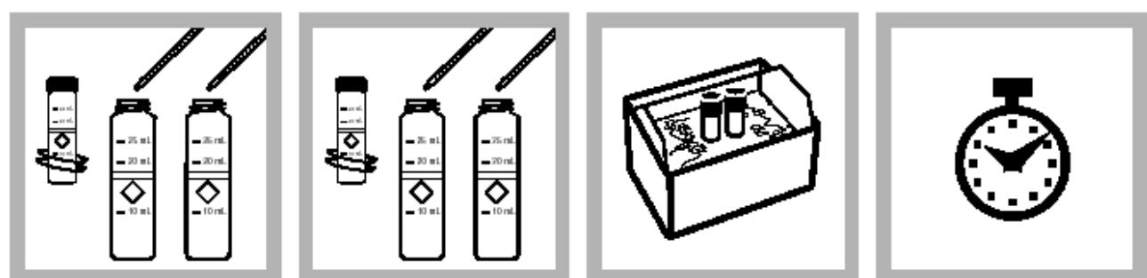
5. 加入1.5mL ethylene glycol到每个比色瓶中。旋转混合。
