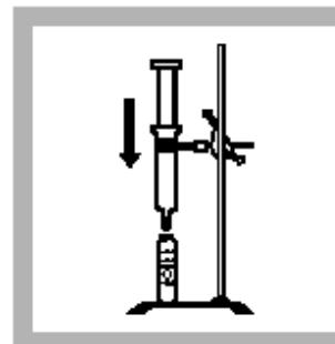
11. 当洗提液开始从萃取器中滴出时，插入活塞，缓慢加压，使剩余的洗提液流过萃取器。紧紧压缩吸收垫。样品管中的液体体积应为 25mL。
