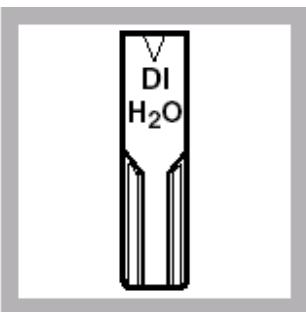
5. 制备1个试管,加入去离子水,标记为零点管. 用清洁干净的棉纸擦拭外壁,以除掉水分,污迹和指纹。
