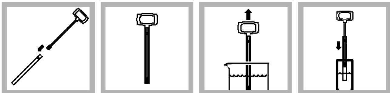
1. 先湿润一下橙色 Teflon® 做的Wiretrol® 滴管的活塞顶端后, 小心的将它插入到毛细管尾部,毛细管的尾部有彩色带状标记。
