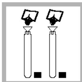
2、取 2 支低浓度总氮试剂管，并用漏斗各加总氮过硫代物药剂于其内。
