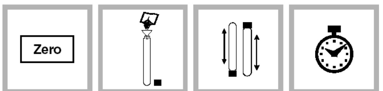
5. 按 ZERO, 屏幕将显示: 0.0 mg/L NO<sub>3</sub>—N。
