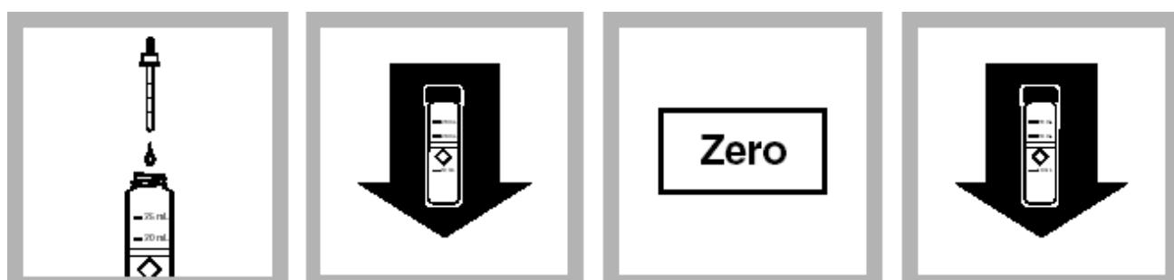
9. 加入一滴 1 M 的 EGTA溶液到比色管中 (待测样品), 混合。
