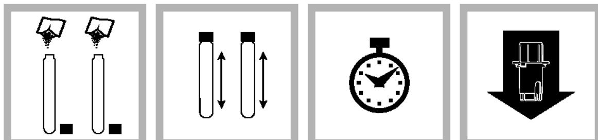
5. 在每个 TNT 管中加入一个氨氮尿酸试剂粉枕
