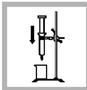
9. 液体流完后，用活塞紧紧压缩萃取器中的吸收垫，弃去大口杯中的溶液，从萃取器中慢慢取出活塞。
