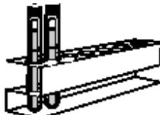
11. 小心将组合瓶从反应器中取出，将它放入试管架。为得到准确结果，让瓶子冷却1小时。注：试剂空白瓶中的液体为深蓝色。
