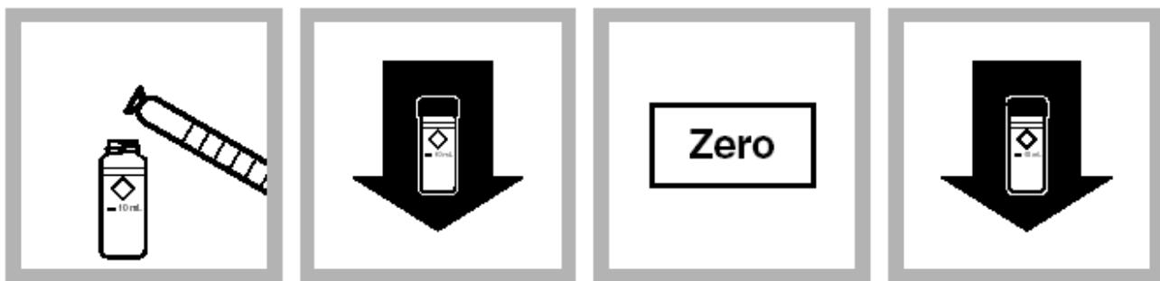
9. 反应期间，从量筒中倒出溶液到比色瓶（待测试样）。
