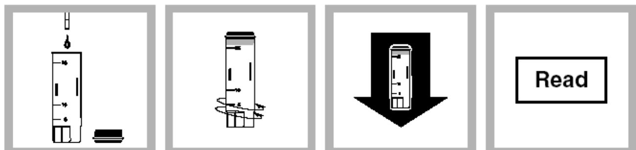
9. 从仪器中取出比色管。加入一滴极低范围硬度用的CDTA试剂。注: 在1-2分钟内完成步骤10-11。
