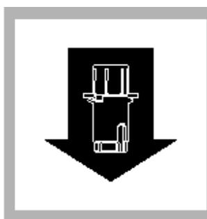
10. 安装16-mm适配器，反应时间到，放入比色管。
