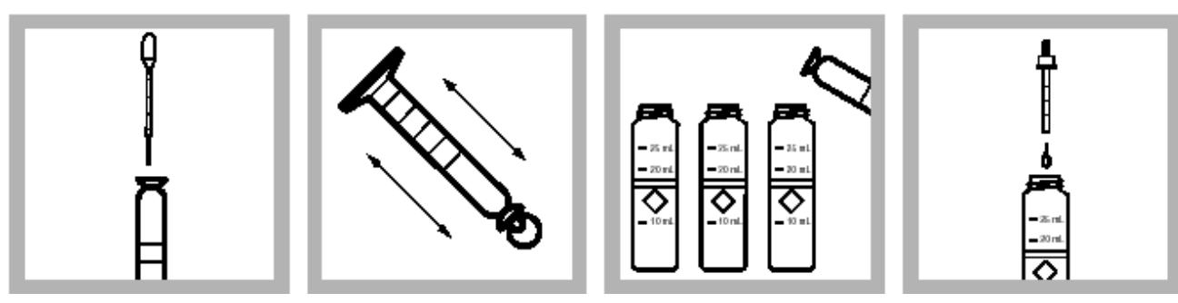
5. 用 1.0mL 的测量点滴器加入 1.0 mL 碱溶液。
