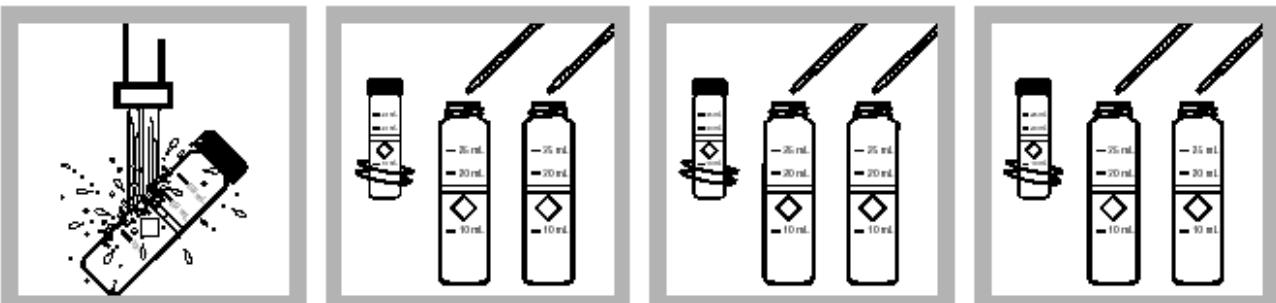
9. 当计时器鸣叫时，用流动的自来水将冷却溶液到 $25^{\circ}\text{C}$ （直到比色瓶冷却到该温度）。
