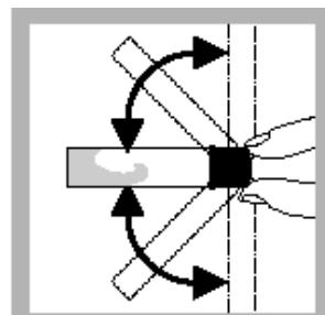
4. 盖好反应管，倒转多次混合混合。
