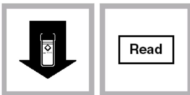
9. 在定时器发出蜂鸣声 1 分钟内，将检测样置入适配器中，读数
