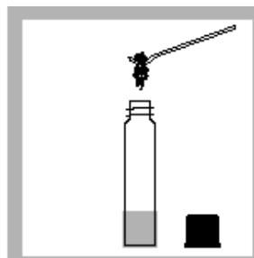
3. 加入一满药匙的Masking A试剂(HCT 152 A)到管内
