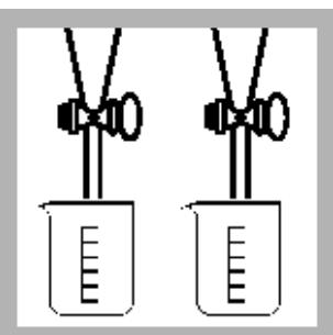
15. 当计时器鸣叫时，分别将两个漏斗中的下层水层分出，弃去。注：完成步骤16到20之前不要超过计时器鸣叫后5分钟。
