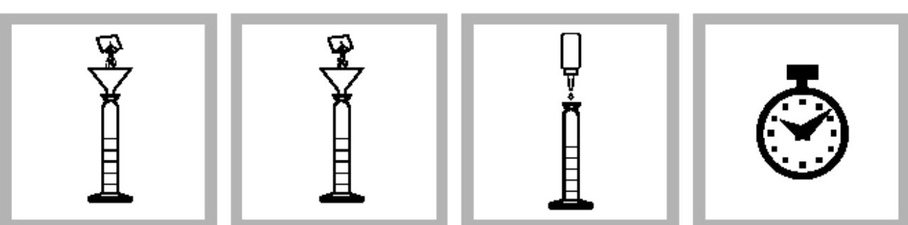
32. 将所收集的溶液加入 HgEX 3 铝箔包试剂, 并摇匀。
