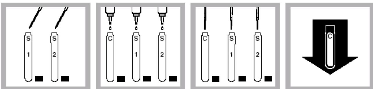
9. 向每个样品试管中加入5.0mL制备的样品液(或稀释液)。为了确认测试毒性的开始点,可以用去离子水稀释1mL样品液至10mL,然后进行测试,观察是否指示为0%,不是就对该稀释液再稀释1/10,按此步骤直到达要求.
