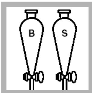
11. 取走盖子，让每个漏斗静置直到氯仿在下层分层。
