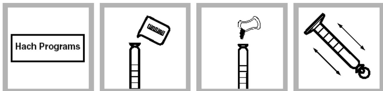
1. 在 HACH PROGRAM下, 选择铁的FerroMo法程序 编 号 275 Iron, FerroMo, 按START。
