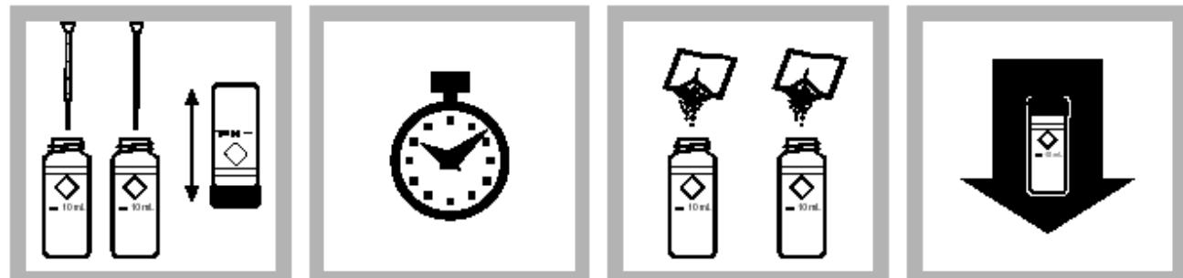
5. 往每个管中分别加入 1.0 mL 0.3% PAN 指示剂溶液, 倒转几次, 混合。
