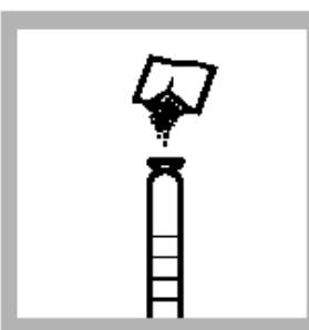
6. 三十秒内, 加入 20mL样品所需用量的 Hexamethylenetetraamine Buffer 试剂粉包, 塞好塞子。
