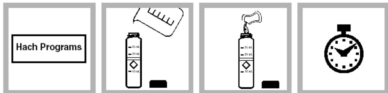
1. 在 HACH PROGRAM下, 选择亚铁的程序255 Iron, Ferrous, 按START。注: 尽可能快地分析样品, 以防止空气将亚铁氧化为铁。
